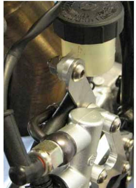
Bremszylinderadapter mit M6x16 am Rastenträger befestigen
