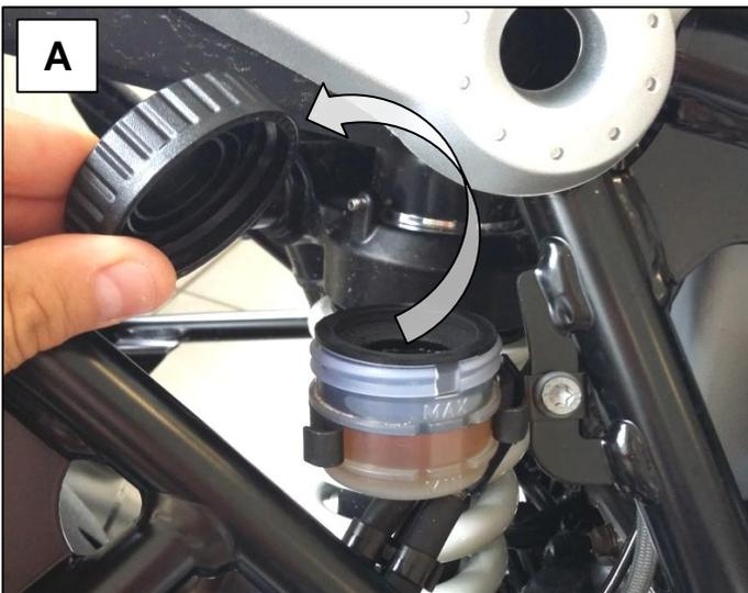
**A:** Montageposition ist der hintere Ausgleichsbehälter der Bremsanlage. entfernen Sie den originalen Deckel durch Herunterdrehen.
