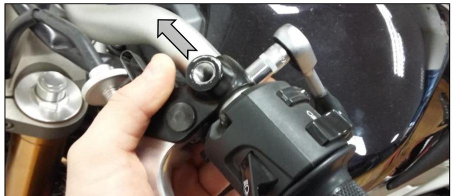
**Option:** Mehr Abstand (Hebel zu Hebelprotektor) durch Verrücken der Kupplungsarmatur auf dem Lenkrohr. Neigungswinkel der Armatur markieren!
