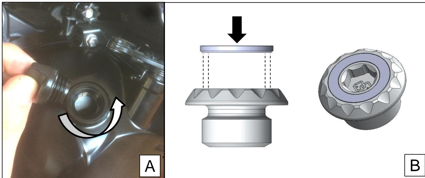
**A:** Entfernen Sie den originalen Öleinfüllstutzen. Achten Sie darauf, dass weder Kleinteile noch grober Schmutz durch die Gehäuseöffnung in das innere des Motors gelangen!
