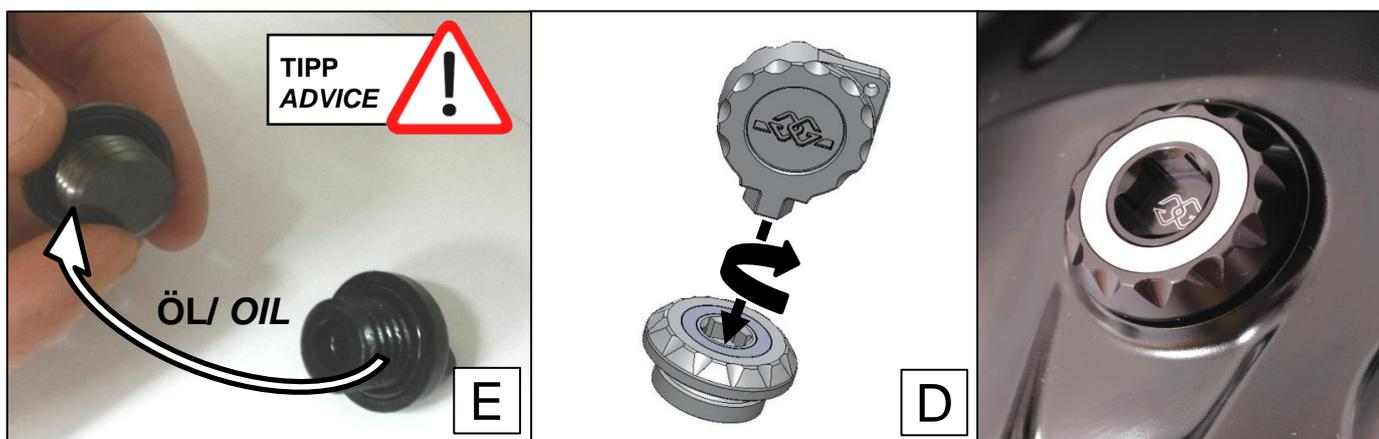
**E:** Bestreichen Sie den Dichtungsring (O-Ring) der Zubehör Öleinfüllschraube mit etwas Motorenöl.
