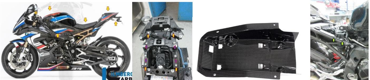
Bitte achten Sie auf genügend Freiraum zu allen umliegenden fest und beweglichen Bauteilen. Bitte ziehen Sie zuerst Schritt für Schritt alle montierten Schrauben handfest an, nach der Kontrolle des korrekten Sitzes des Bauteils ziehen Sie bitte alle Schrauben unter Einhaltung und Vorgabe der originalen Anzugsdrehmomente fest.
